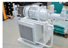
Wir erweitern jeden Standard-Kühler zu einem kompakten Bypass Kühl-Filter-System für Ihre Hydraulikanlage.
