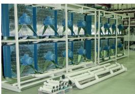
Zur Erhöhung der Kühlleistung können wir mehrere Kühler (2 bis 16 Stück) zu einem System montieren.
